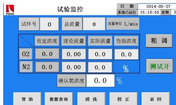
(5) 设置试样号，系统自动将流量置标准流量 14.71/min，氧浓度 20.9%。粗调点击此按钮将显示细调，表明按图 1 中的 0+或 0-按 1%增加转为按 0.1%增加，侧文本框显示计算氧指数值。
