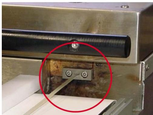
(8) 打开仪器密炼腔，然后将两个螺杆分别卸下，用铜刷和铜铲清除物料。
