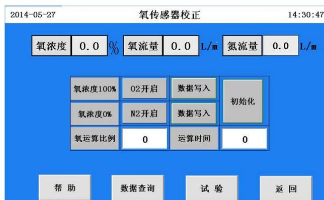
校正时先通入氧气，按下 氧气开按钮，管路直接通入氧气，等待实时氧指数显示稳定，可以按下相对应的数据写入按钮，再按下氧气开按钮，关闭氧气。再通入氮气，按下氮气开按钮，管路直接通入氮气，等待实时氧指数显示稳定，可以按下相应的数据写入按钮，再按下氮气开按钮，关闭氮气，如果校
