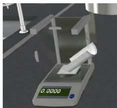
（1）打开电子天平开关；打开分析天平开关和右侧门；
